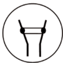
IEC/EN 60947-5-1 Contatos mecanicamente conectados
